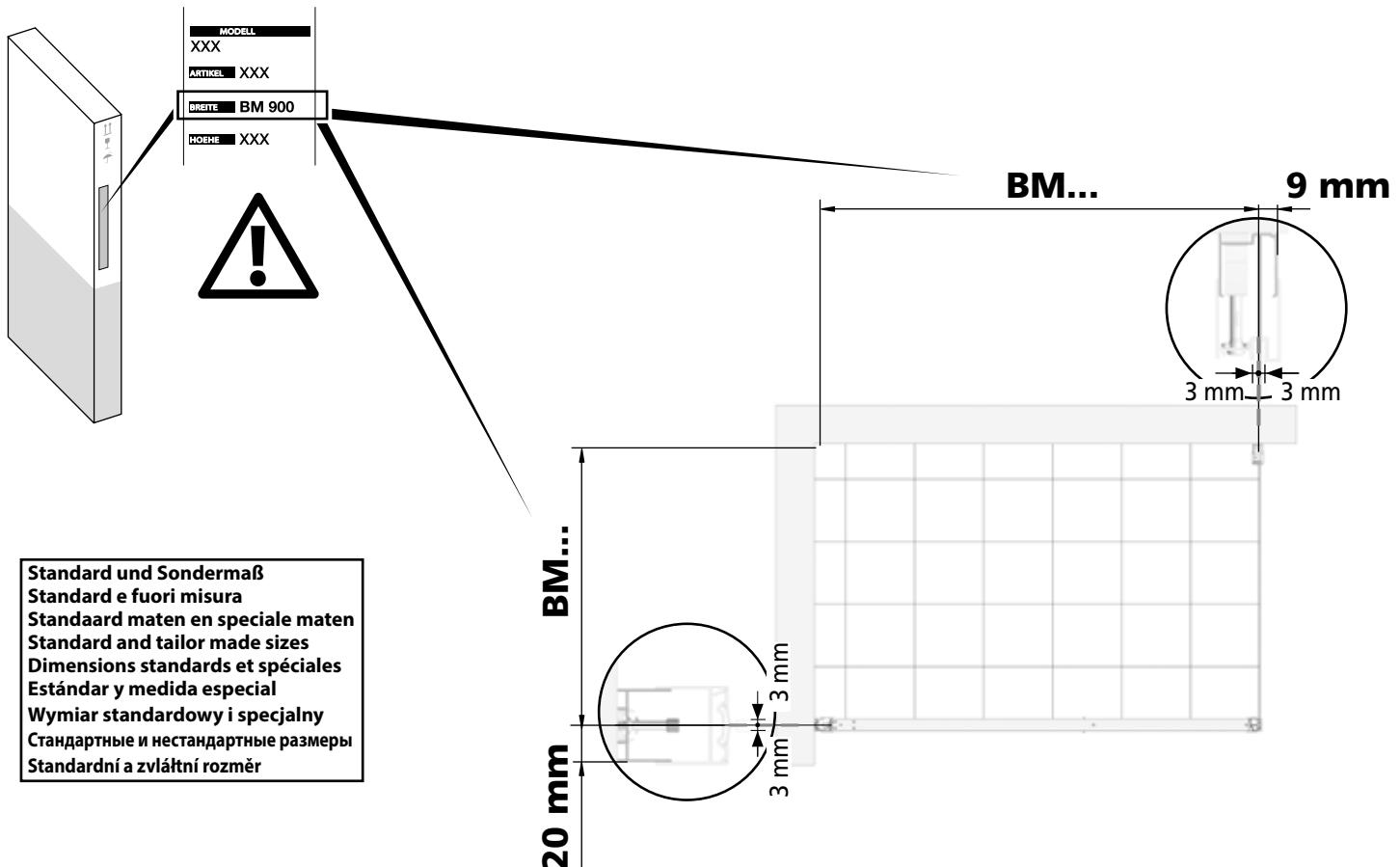
Montage Außenkante Profil | Montaggio senza centro vetro | Montage buitenkant profiel | Installation outer edge profile| Montage profil extérieur | Instalación perfil en el exterior | Montaż po zewnętrznej stronie profilu | Монтаж внешний профиль края | Montáz vnější profil hrany
